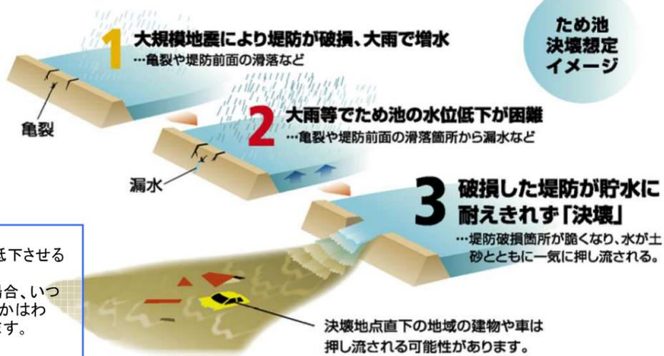
緊急事態においては、ため池の水位を低下させるなど、決壊を防ぐための処置を行います。ただし、想像以上の大災害が発生した場合、いつどのような状況で丸尾池が決壊してしまうかはわからないため、最悪の状況を想定しています。
