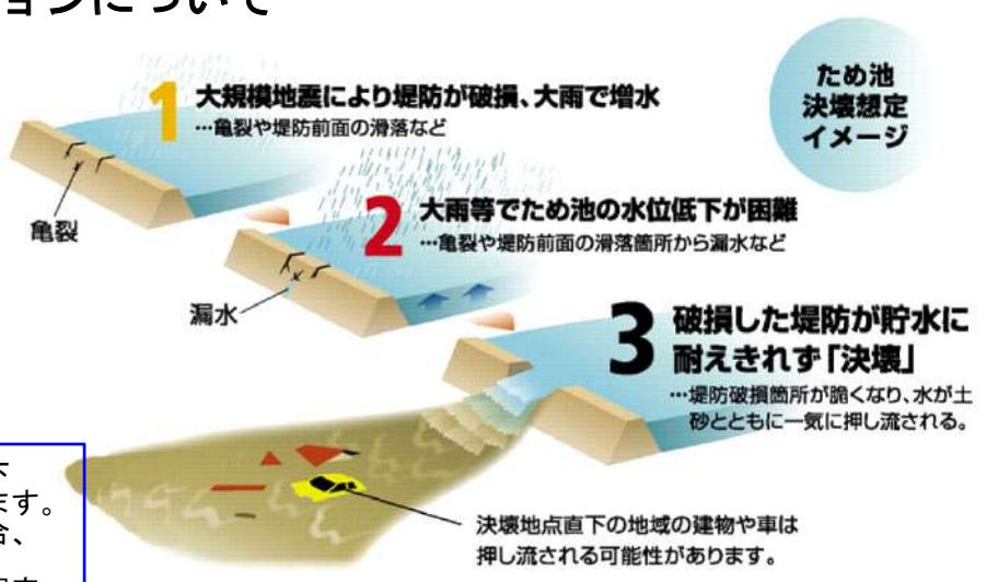
緊急事態においては、ため池の水位を低下させるなど、決壊を防ぐための処置を行います。ただし、想像以上の大災害が発生した場合、いつどのような状況で待池が決壊してしまうかはわからぬため、最悪の状況を想定しています。
