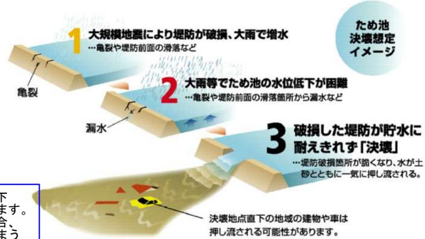
緊急事態においては、ため池の水位を低下させるなど、決壊を防ぐための処置を行います。ただし、想像以上の大災害が発生した場合、いつどのような状況で中の池が決壊してしまうかはわからないため、最悪の状況を想定しています。
