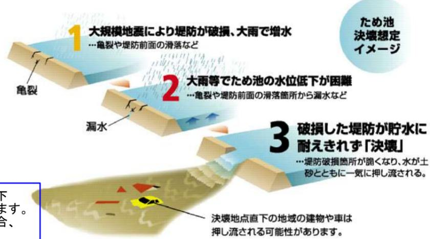
緊急事態においては、ため池の水位を低下させるなど、決壊を防ぐための処置を行います。ただし、想像以上の大災害が発生した場合、いつどのような状況で瀬野の池が決壊してしまうかはわからないため、最悪の状況を想定しています。
