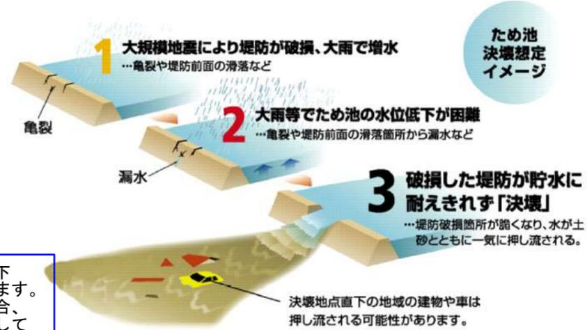
緊急事態においては、ため池の水位を低下させるなど、決壊を防ぐための処置を行います。ただし、想像以上の大災害が発生した場合、いつどのような状況で下池（七山）が決壊してしまうかはわからないため、最悪の状況を想定しています。
