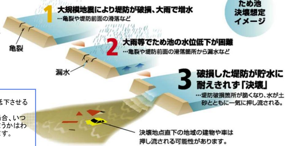
緊急事態においては、ため池の水位を低下させるなど、決壊を防ぐための処置を行います。ただし、想像以上の大災害が発生した場合、いつどのような状況で高津濁池が決壊してしまうかはわからないため、最悪の状況を想定しています。
