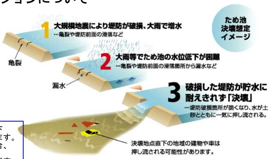
緊急事態においては、ため池の水位を低下させるなど、決壊を防ぐための処置を行います。ただし、想像以上の大災害が発生した場合、いつどのような状況で字の池が決壊してしまいかはわからぬため、最悪の状況を想定しています。
