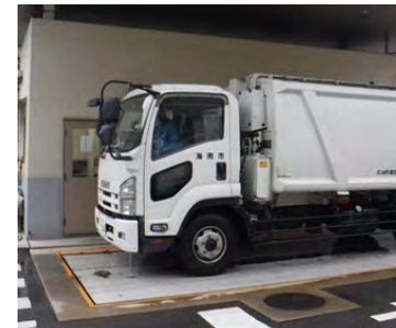
紀の海クリーンセンター内の計量器で ごみの重量を計測
