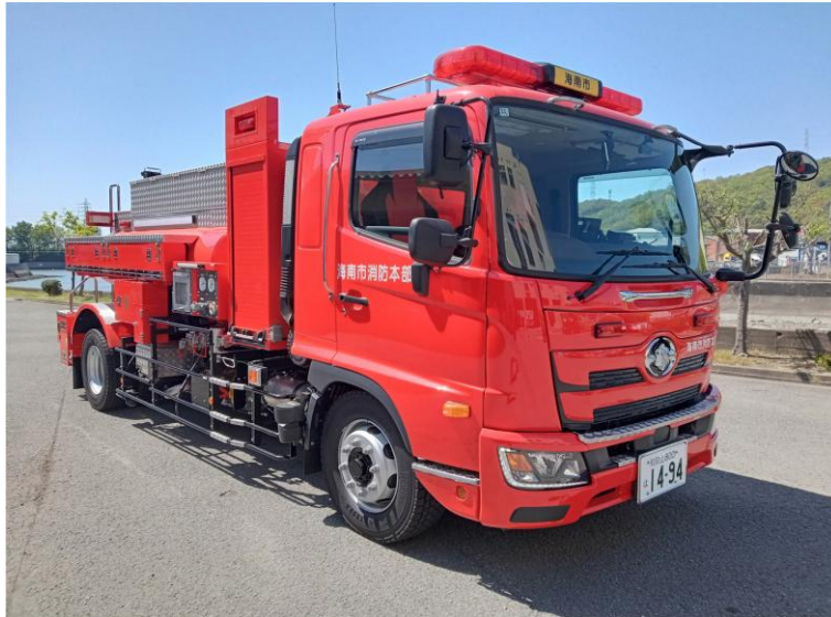
泡原液搬送車 (海南署 配備)
