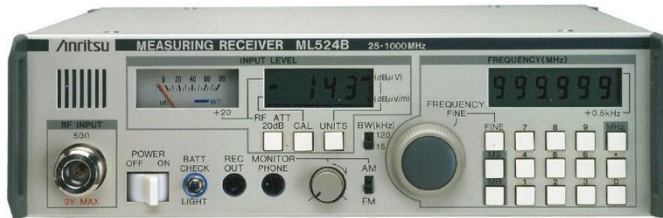
(図3 電界強度測定器【右のアンテナにつなぎ測定】) (図4 標準ダイポールアンテナと4 mポール)
