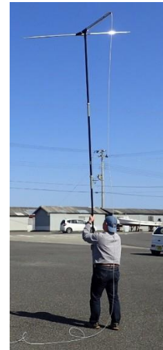
(図3 電界強度測定器【右のアンテナにつなぎ測定】) (図4 標準ダイポールアンテナと4 mポール)
