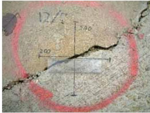
コンクリートなどの人工の構造物に生じた亀裂に長さを設定して十字のマークを付け、その変化を観測することによって、亀裂が拡がりを確認できます。簡単に測定できますが、時間がたつと線がかすれてきてしまうので、長期の観測には不向きです。
