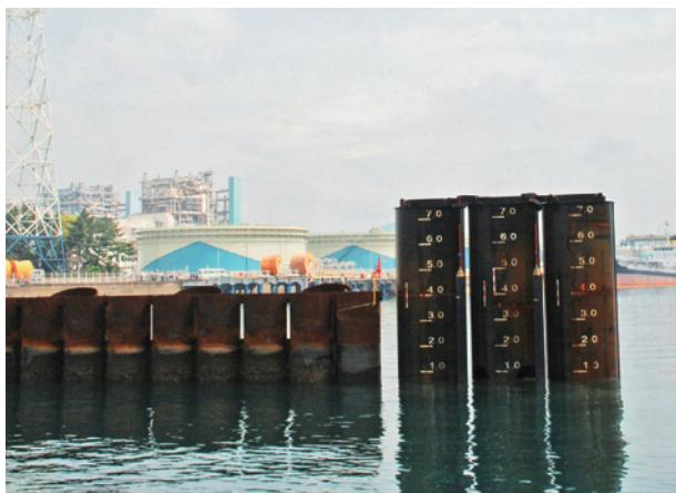
浮上動作確認実験で浮上した津波防波堤
